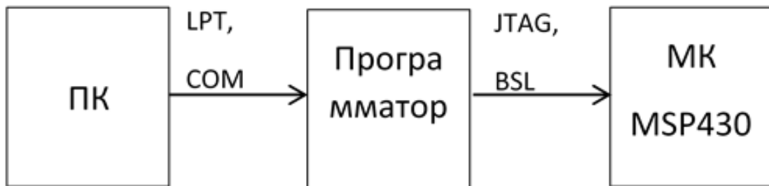
Рисунок 3.9 – Схема прошивки микроконтроллеров семейства MSP430.
