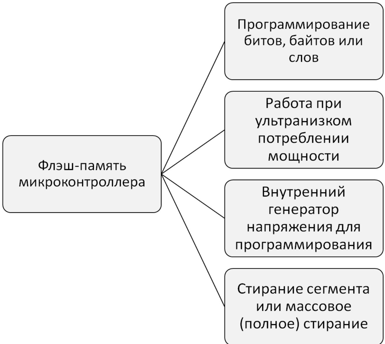
Рисунок 3.4 – Возможности флэш –памяти микроконтроллера.
