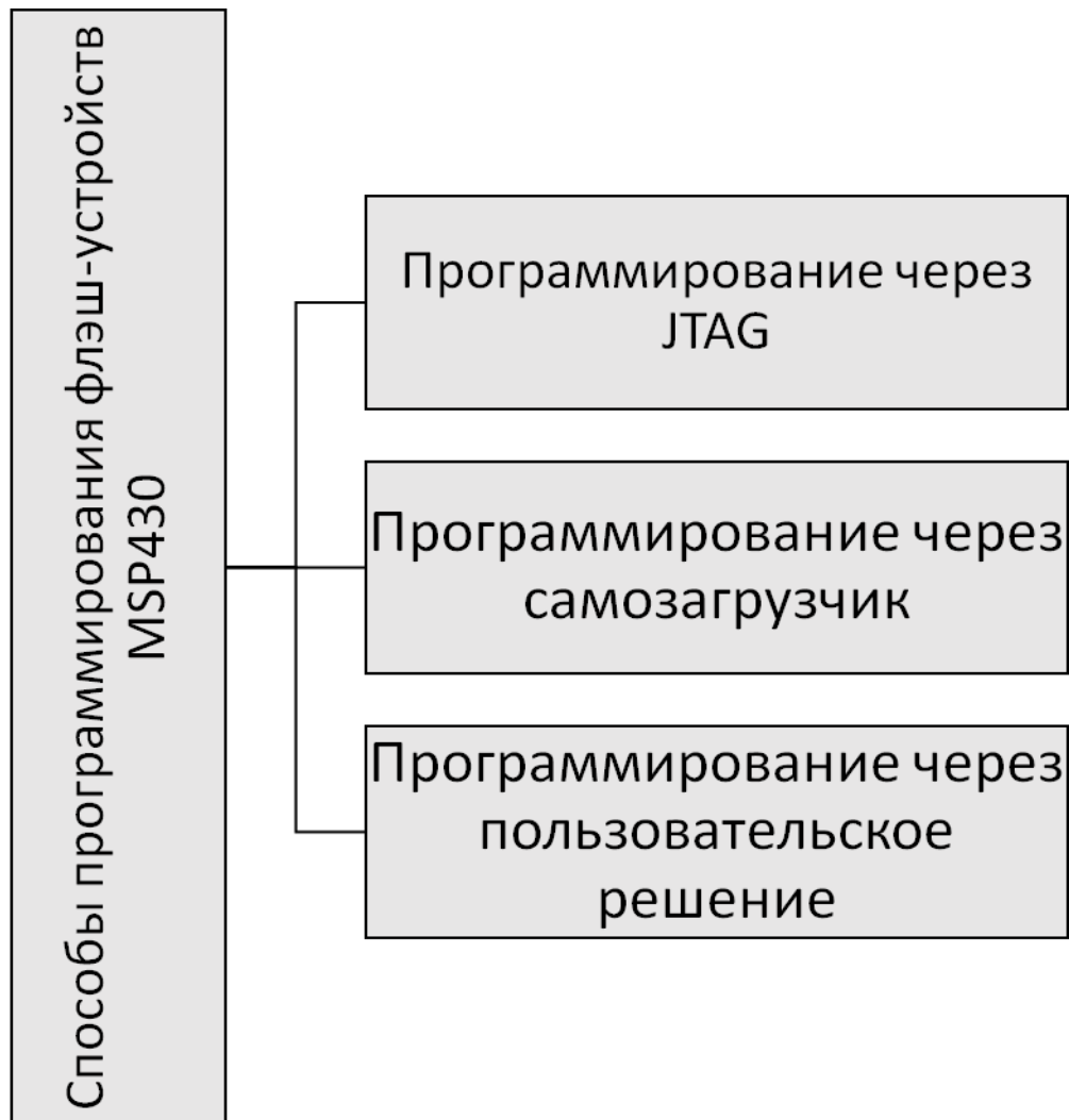
Рисунок 3.7 - Способы программирования флэш-устройств MSP430.
