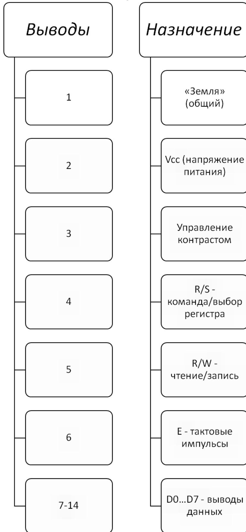
Рисунок 2.12 - Назначение контактов ЖК индикатора типа HD44870.
