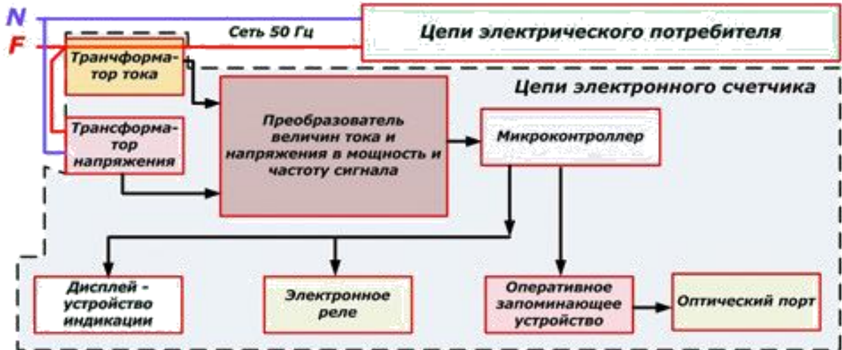
Рисунок 1.8 – Структурная схема электронного однофазного счетчика.
