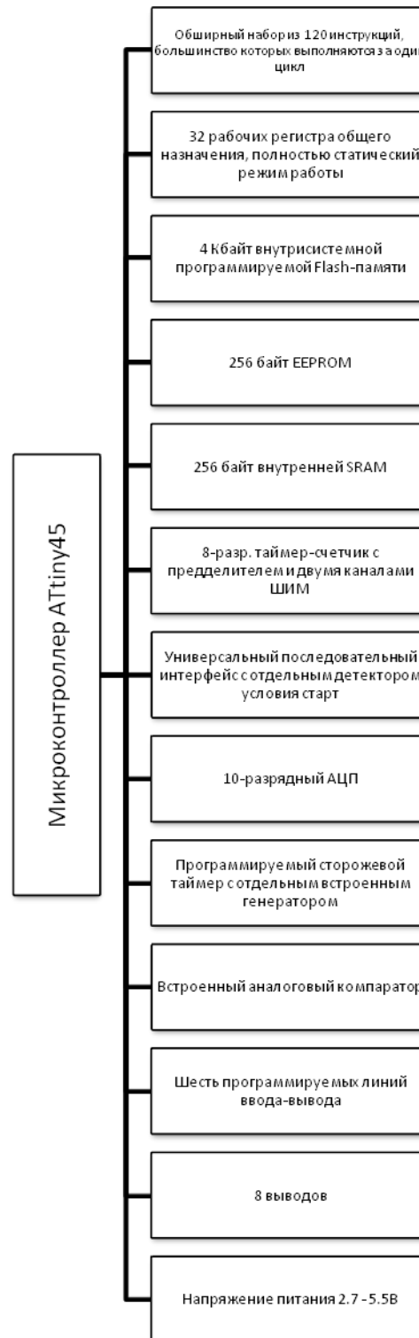
Рисунок 2.5 - Основные характеристики микроконтроллера ATtiny45.
