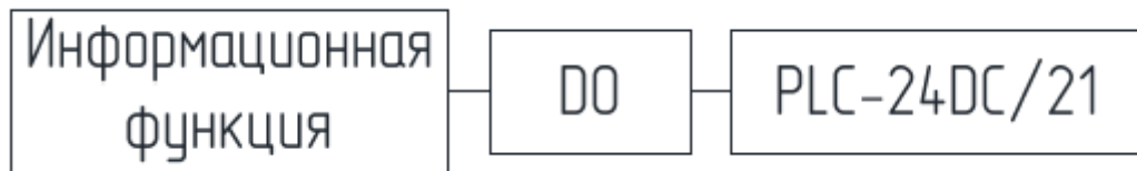
Рисунок 9 - Структурная схема соединений элементов надежности для управляющей функции дискретного вывода
