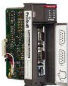
Рисунок 5.1 – Модуль процессора
