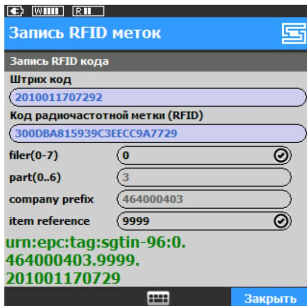
Рисунок 3.5 – Запись RFID метки
