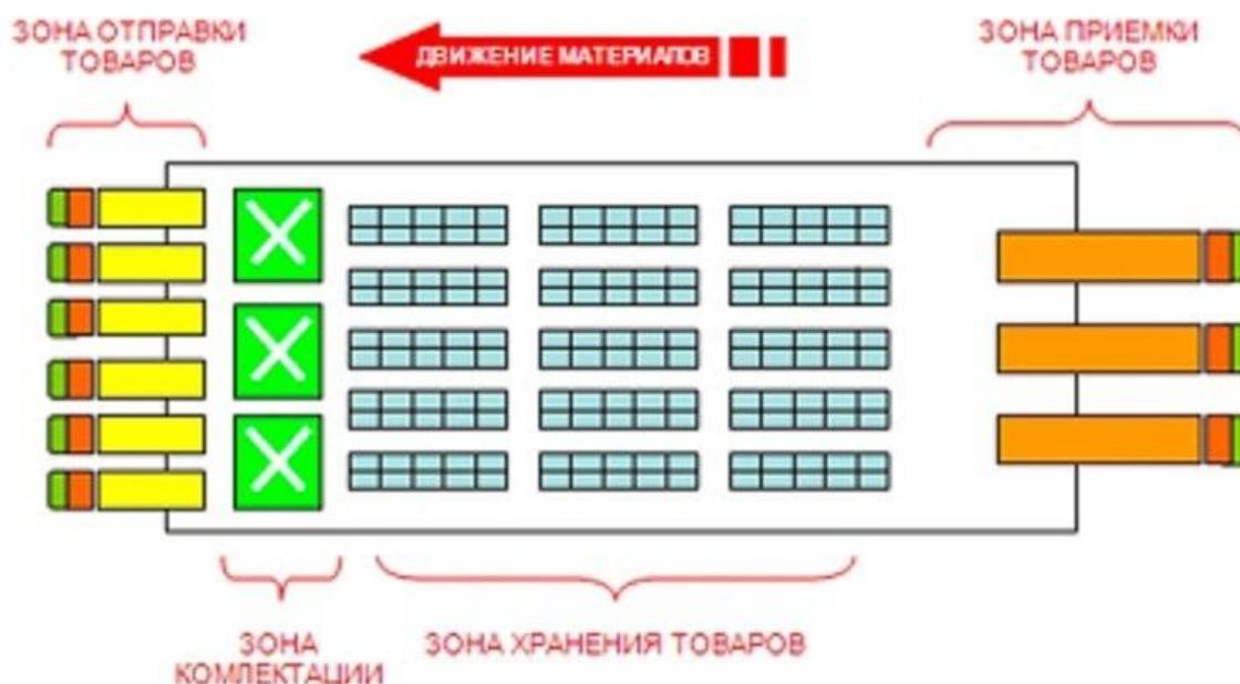
Рисунок 4.1 – Схема движения материалов
