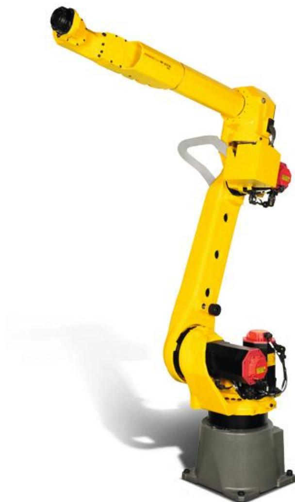
Рисунок 4.4 – Промышленный робот ПРЦ-1
