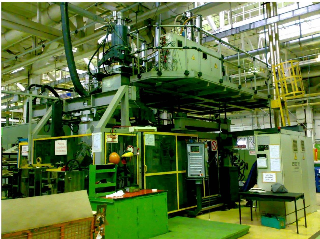
Рисунок 4.1 – Экструзионно-выдувная установка KBS2-61/60
