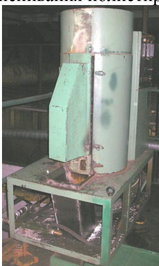
Рисунок 1.6 – Установка непрерывного вспенивания полистирола
