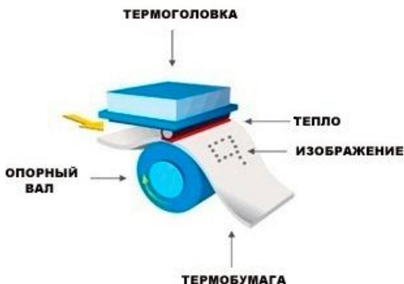
Рисунок 5.5 – Устройство термопечати
