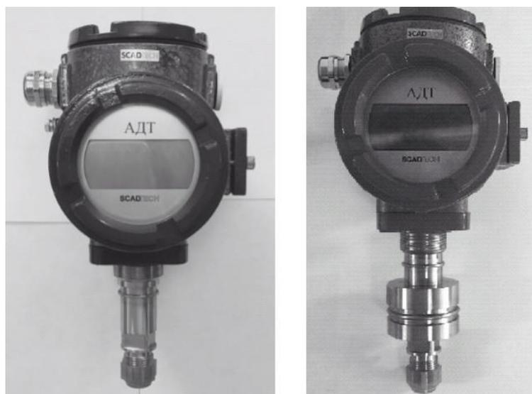
Рисунок 3.3 – Датчик давления АДТ ДИ 4033
