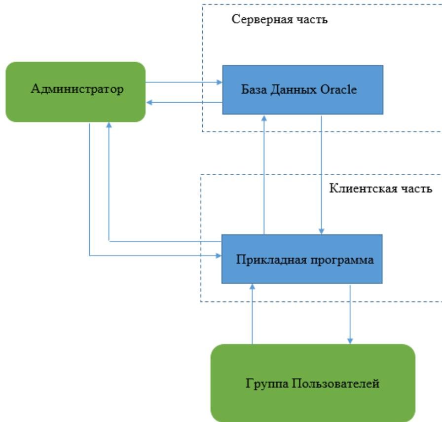
Рисунок.2.1 Структурная схема автоматизированной систем ведения учета сертификатов
