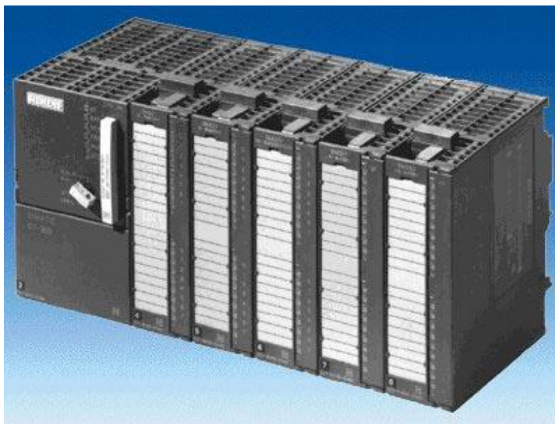
Рисунок 4.1 – Общий вид ПЛК SIMATIC S7-200
