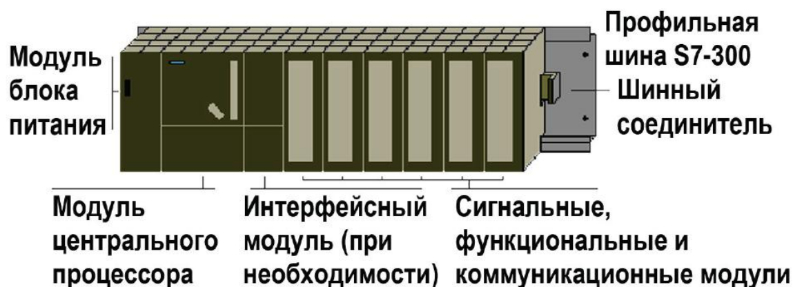
Рисунок 4.6–Конструкция Simatic S7-300
