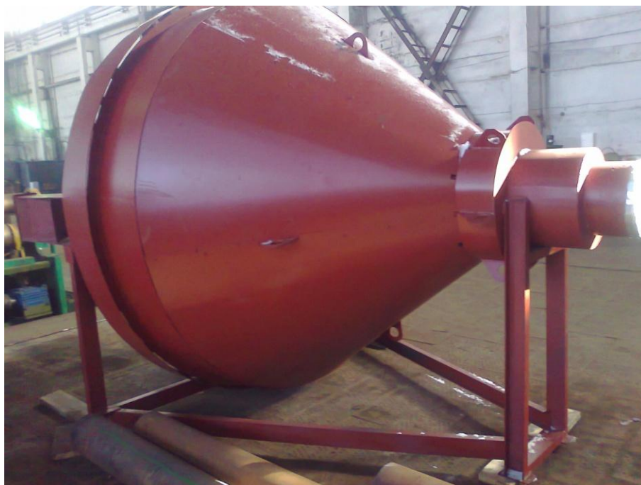
Рисунок 3.5 – Глушитель шума при выпуске сжатого воздуха из пневмосистемы
