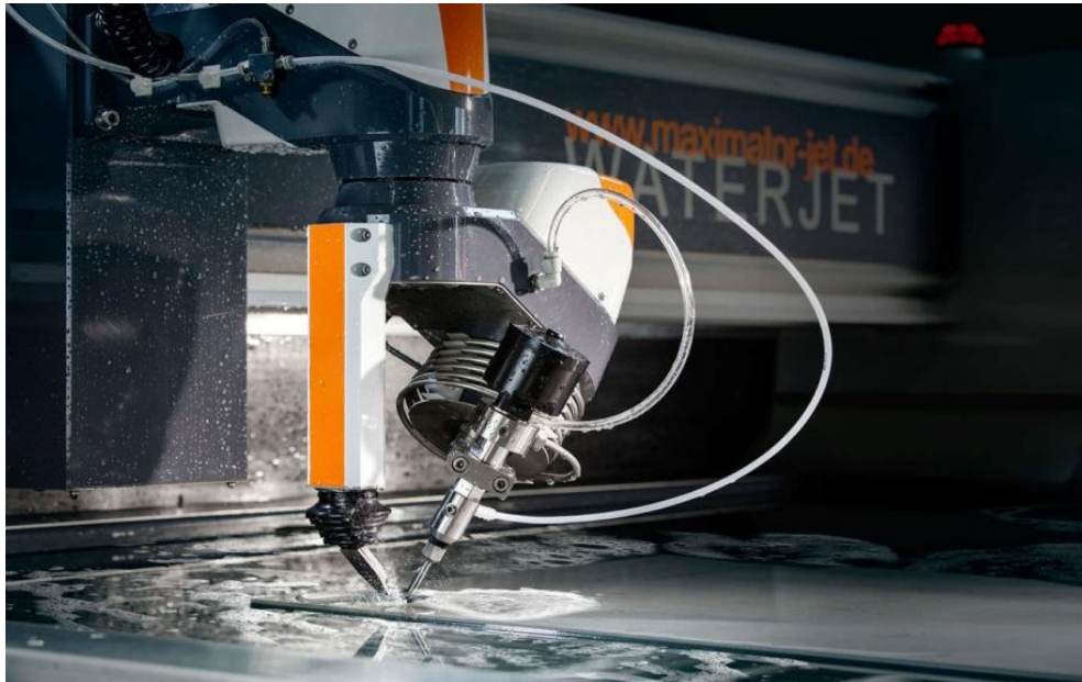
Рисунок 2.5 – Манипулятор робота гидроабразивной резки
