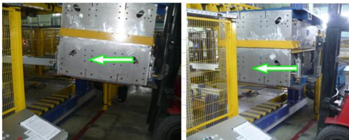
Рисунок 2.2 – Установка пресс-формы на нижнюю плиту прессы
