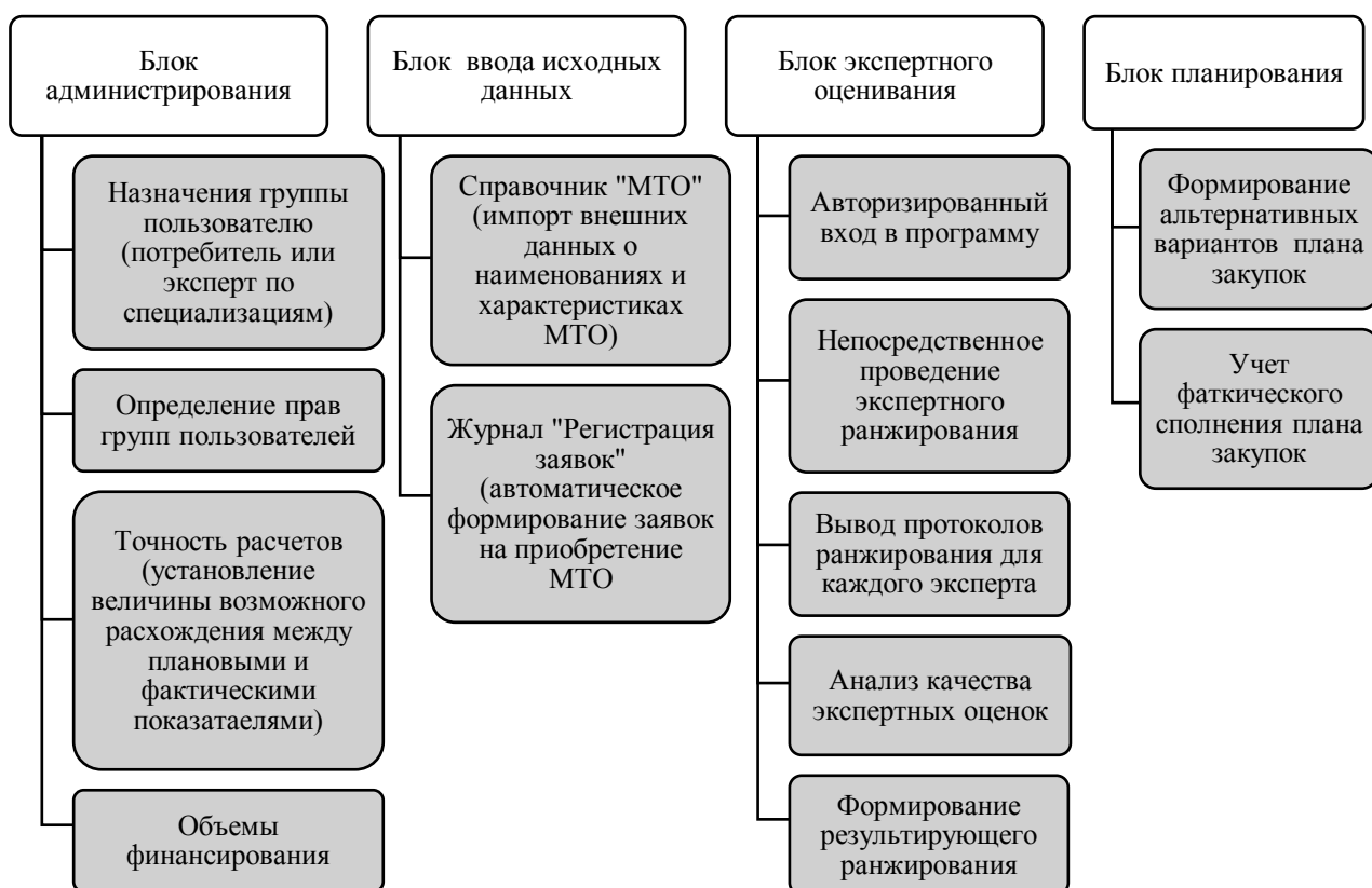
Рисунок 7 – Структурная схема КИС «Галактика»
