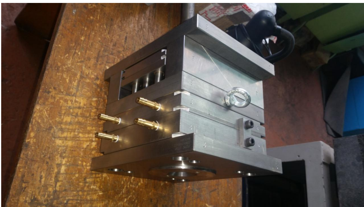
Рисунок 3.2 – Изготовленная с использованием фрезерного обрабатывающего центра пресс - форма
