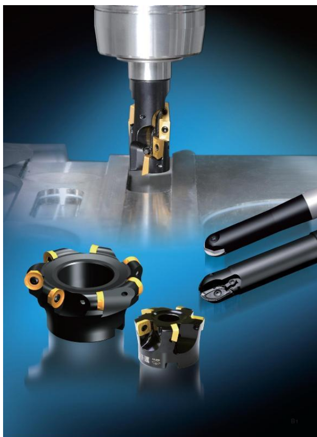
Рисунок 3.11 – Концевая и сферическая сборные фрезы, используемые в современных вертикально – фрезерных обрабатывающих центрах
