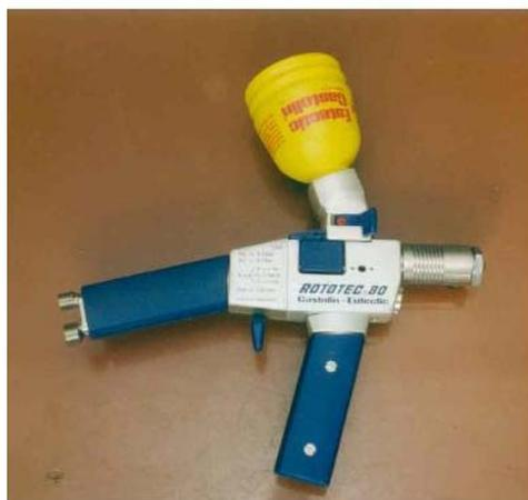
Рис. 4.2. Газопламенная горелка Rototec-80
