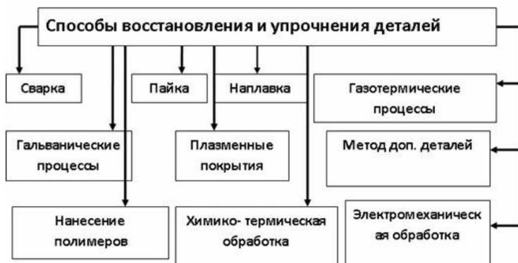
Рис. 1.1. Способы восстановления и упрочнения поверхностей деталей
