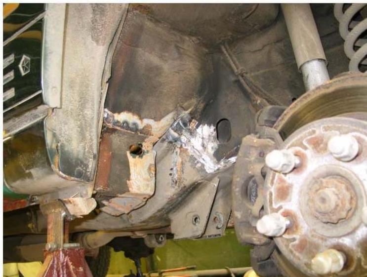
Рис. 7.3. Заваренный участок переднего лонжерона кузова автомобиля механизированной сваркой в среде углекислого газа
