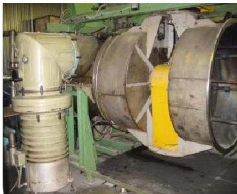
Рис. 4.15. Установка вакуумная для нанесения покрытий 1АП487
