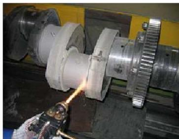
Рис. 7.22. Процесс газотермического напыления шеек коленчатого вала
