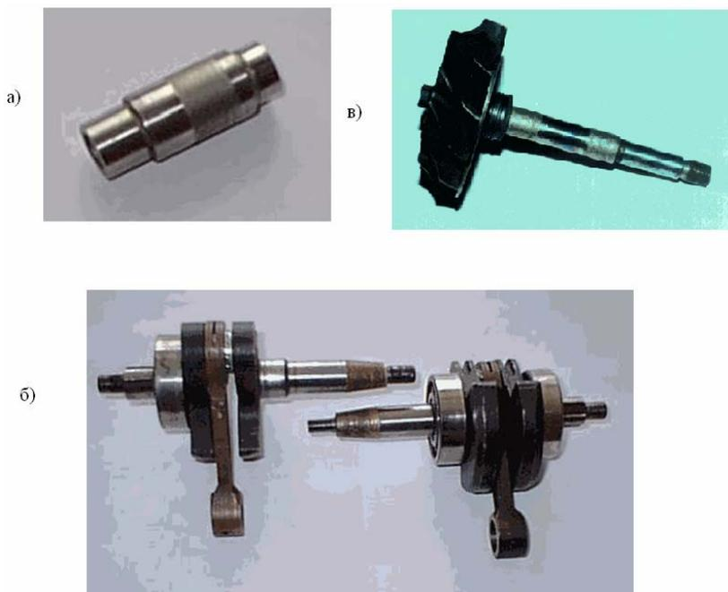
Рис. 4.21. Детали, восстановленные и упрочненные с помощью ЭИЛ
