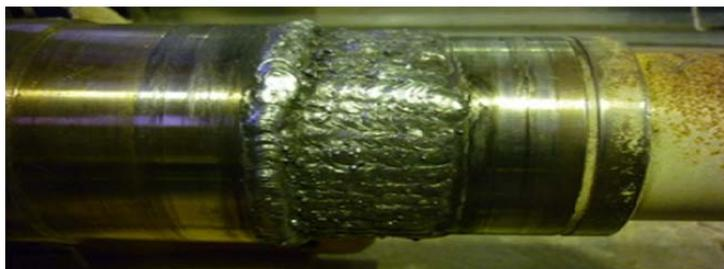
Рис. 7.12. Наплавленная поверхность шлицевого вала
