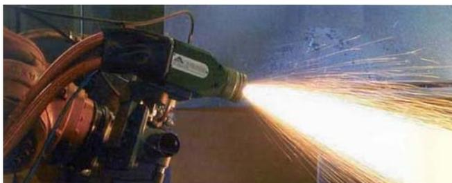
Рис. 4.13. Работа металлатора при нанесении покрытия
