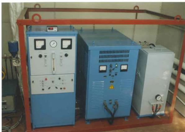
Рис. 4.9. Установка для плазменного напыления УПУ-3Д
