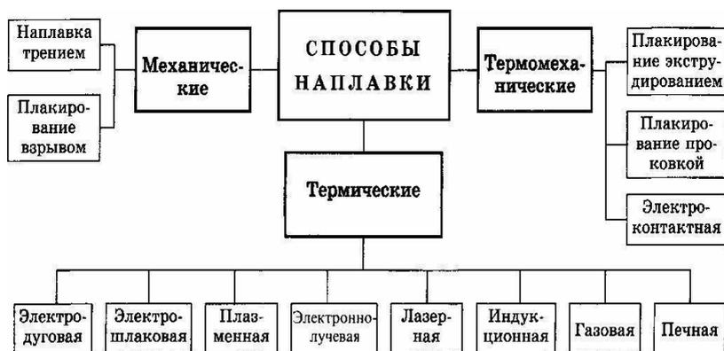
Рис. 3.1. Способы наплавки
