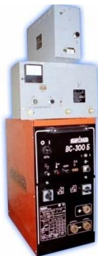
Рис. 7.2. Полуавтомат сварочный А-547У в комплекте с выпрямителем ВС-300Б
