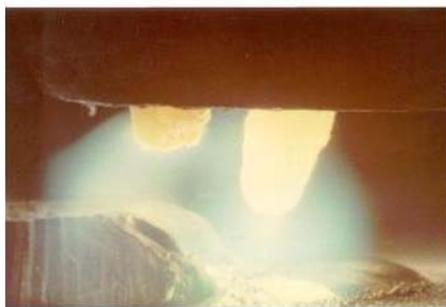
Рис. 3.36. Наплавка трехфазной дугой с подачей крупногабаритной присадки
