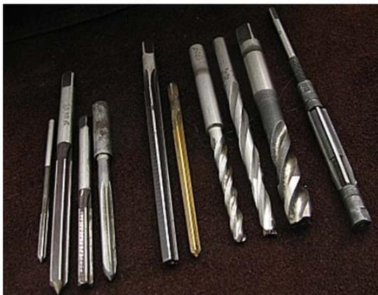
Рис. 2.17. Развертка – режущий инструмент, который нужен для окончательной обработки отверстий после сверления, зенкерования или растачивания
