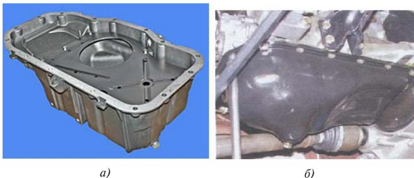
Рис. 7.24. Поддон картера двигателя: *а* – внешний вид поддона; *б* – поддон установлен на картере двигателя
