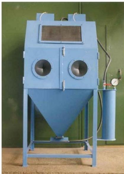
Рис. 1.2. Камера для дробеструйной обработки деталей (стационарная)
