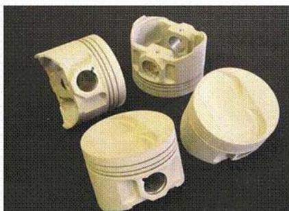
Рис. 6.4. Поршни ДВС с МДО-покрытием
