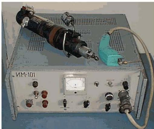
Рис. 4.19. Универсальная механизированная высокочастотная установка для электроискрового легирования ИМ-101
