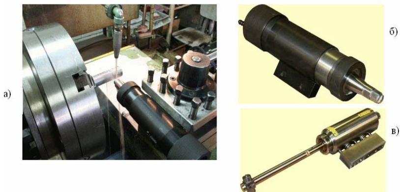
Рис. 2.15. Ультразвуковая импульсная упрочняюще-чистовая обработка деталей: *а* – упрочнение цилиндрической детали на токарном станке; *б* – инструмент для обработки внешних поверхностей; *в* – для обработки внутренних поверхностей
