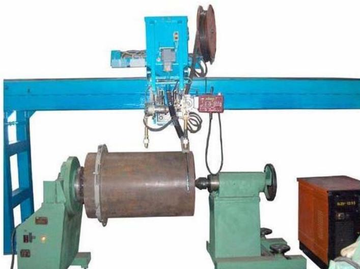
Рис. 3.9. Установка УНВ-3-5 для дуговой наплавки тел вращения
