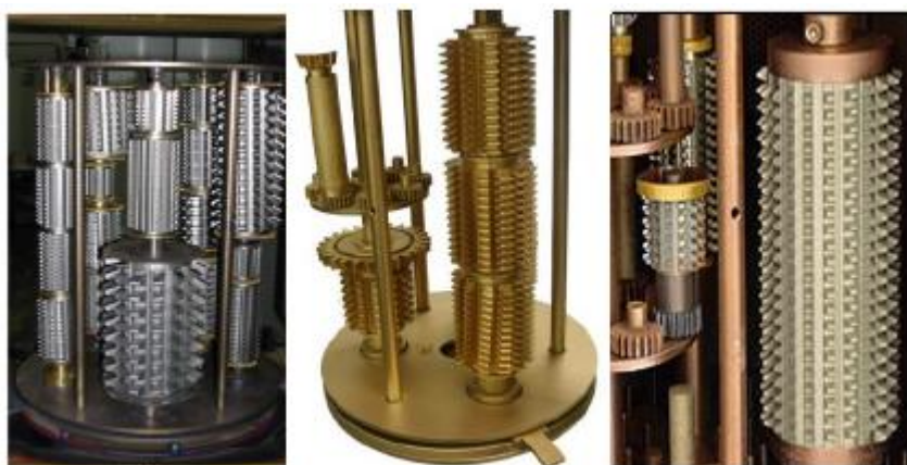
Рисунок 4.1 – Фрезы червячные в установке фирмы Platit для нанесения износостойкого покрытия.
