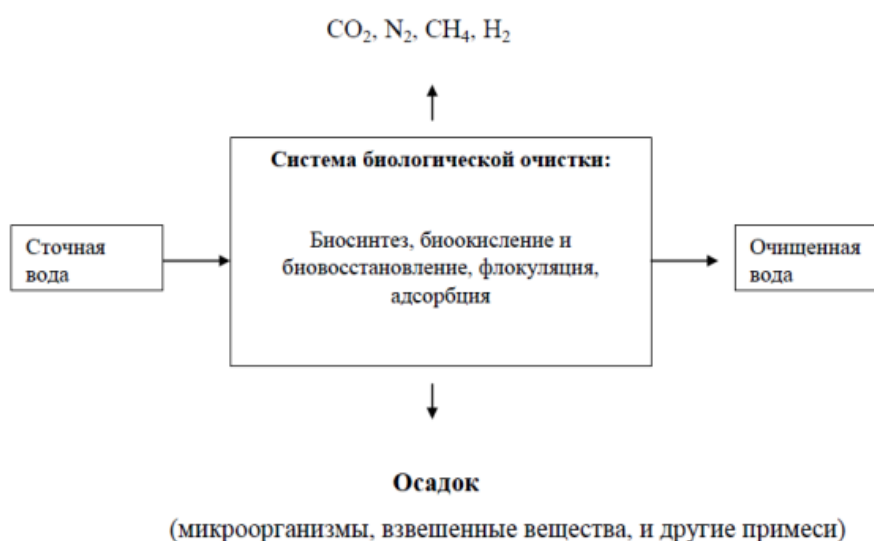
Рисунок 17 - Схема биологической очистки сточных вод (по Большакову Н. Ю.)
