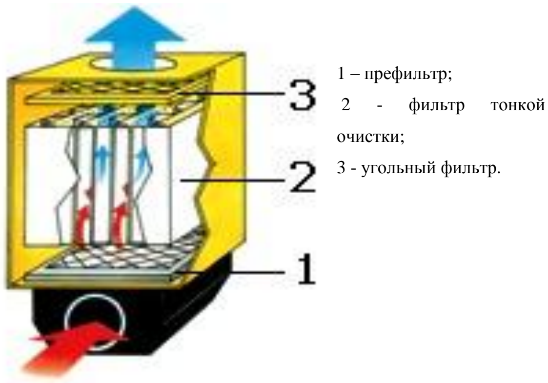
Рисунок 18 – Устройство кассетного фильтра
