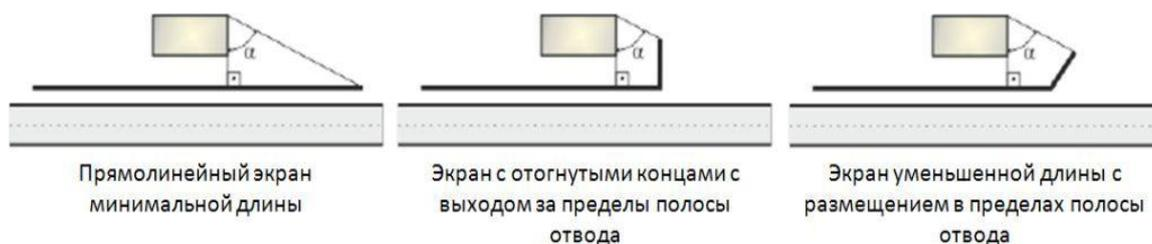
Рисунок 7 – схемы сокращения длины шумозащитного экрана
