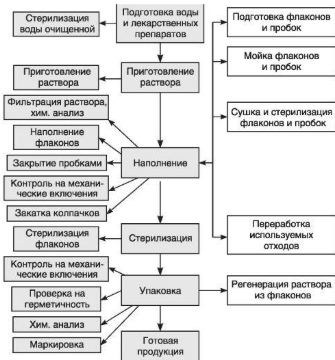
Схема производства стерильных лекарственных средств.
