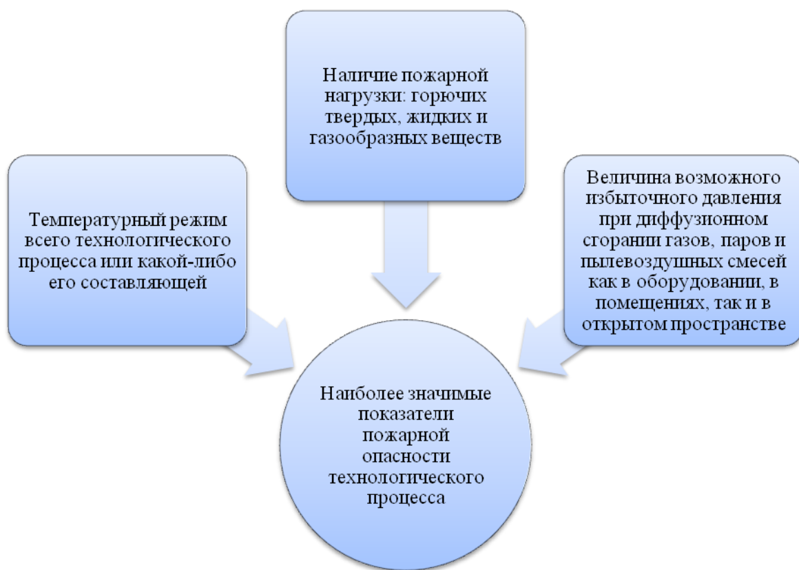
Рисунок 37 - Первоочередные составляющие пожарной опасности технологического процесса
