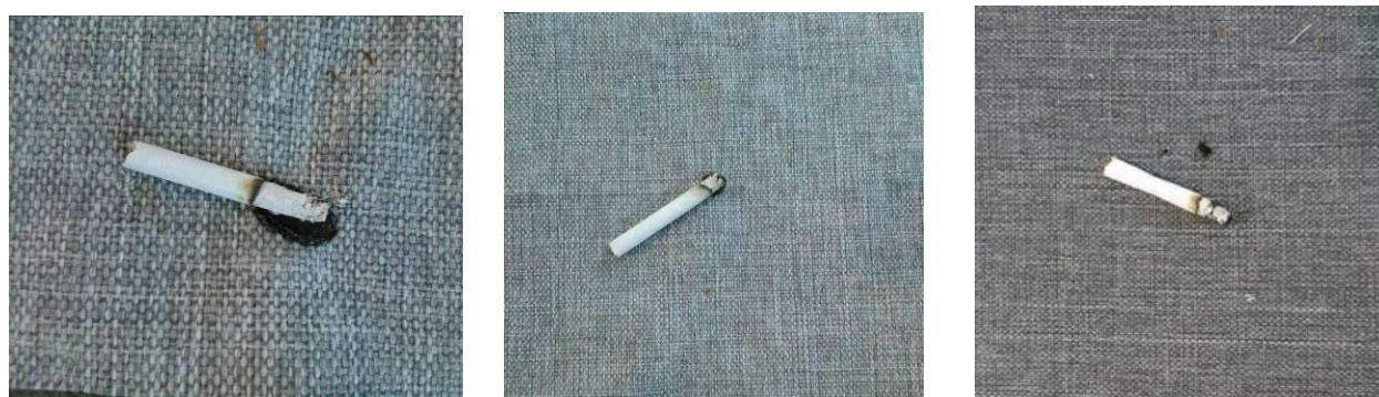
Рисунок Е.2 – Результаты проведения 1 метода испытания (сигарета) для текстильного материала «Сирия»
