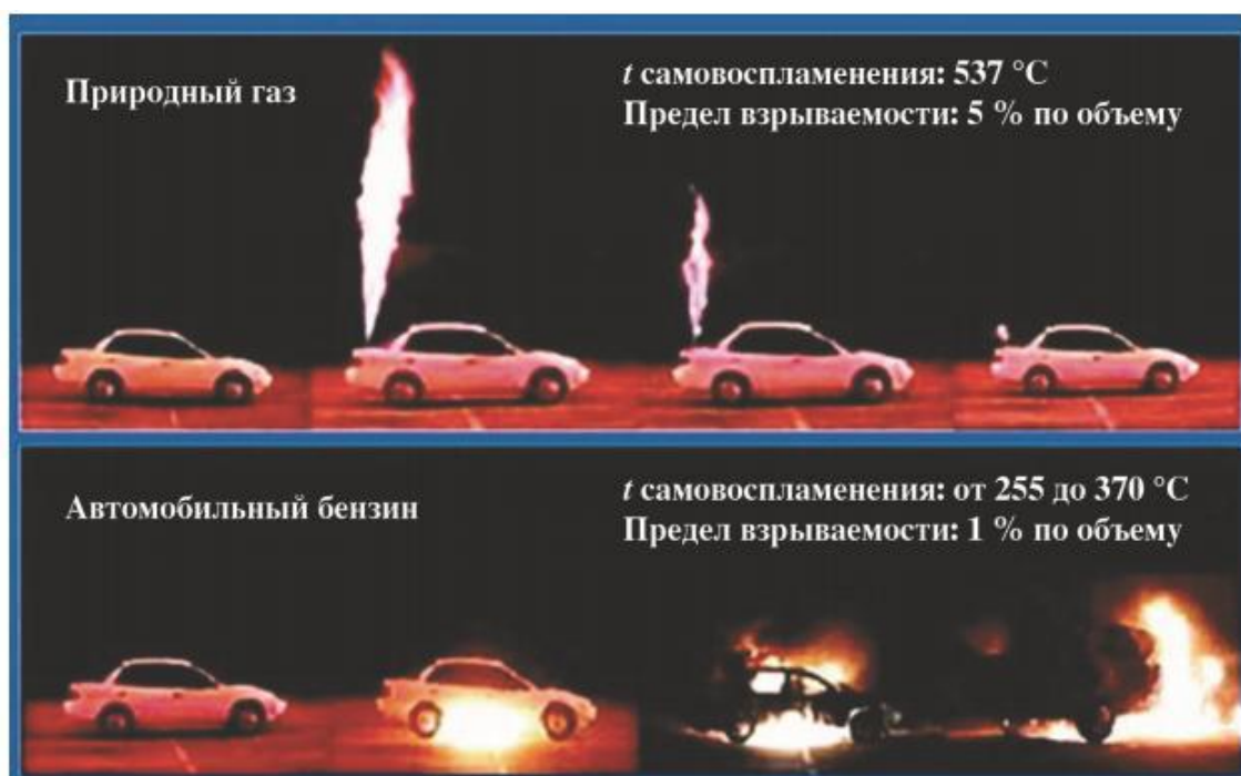
Рисунок 6 – Процесс воспламенения природного газа и бензина
