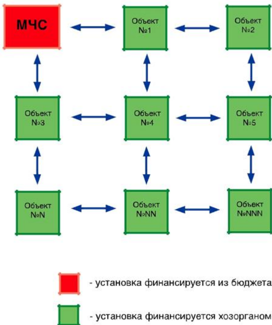
Рисунок 3.8 - Структура системы «Стрелец-Мониторинг» представлена моделью, где каждый объект ретранслятор
