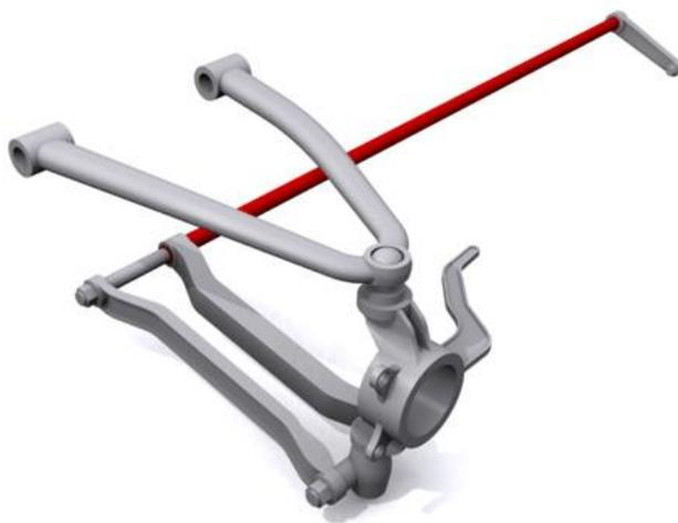
Рисунок 1.6- Схема торсионной подвески.
