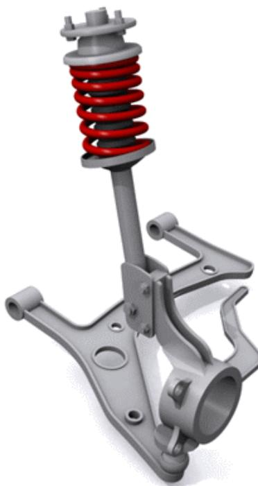
Рисунок 1.1- Схема подвески типа "МакФерсон".
