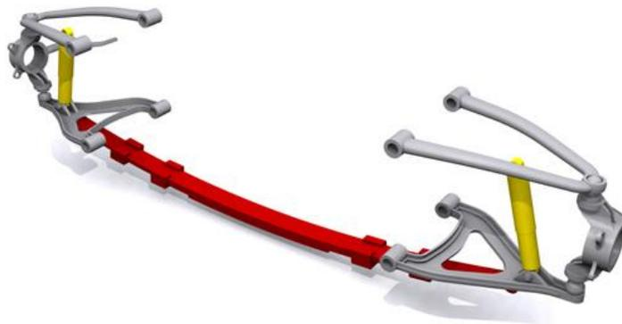
Рисунок 1.7-Схема рессорной подвески.
