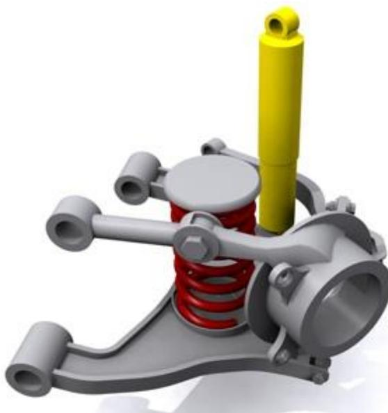
Рисунок 1.5- Схема многорычажной подвески.
