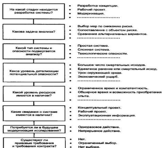
Рисунок 2 - Типовые рассуждения при выборе типа анализа и глубины исследования
