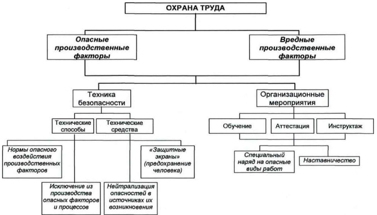
Рисунок 3.1. Схема обеспечения защищенности человека на производстве
