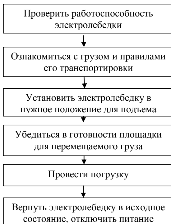
Рисунок 2.3 - Технологическая карта процесса погрузки электролебедкой
