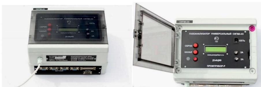
Рисунок 6 – Внешний вид блока информационного СИГМА-03.ИПК
