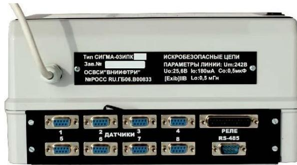
Рисунок 7 – Вид задней панели блока информационного
