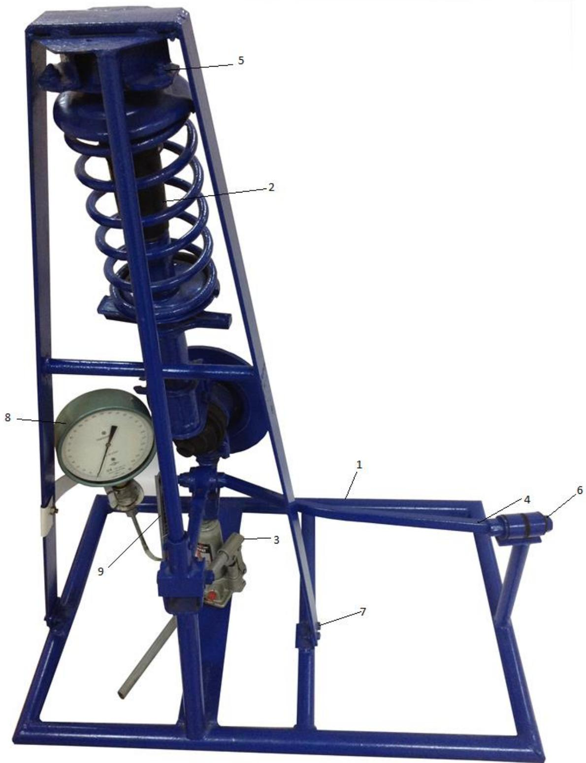
1 - рама в сборе; 2 - стойка телескопическая; 3 - домкрат; 4 - рычаг в сборе;
