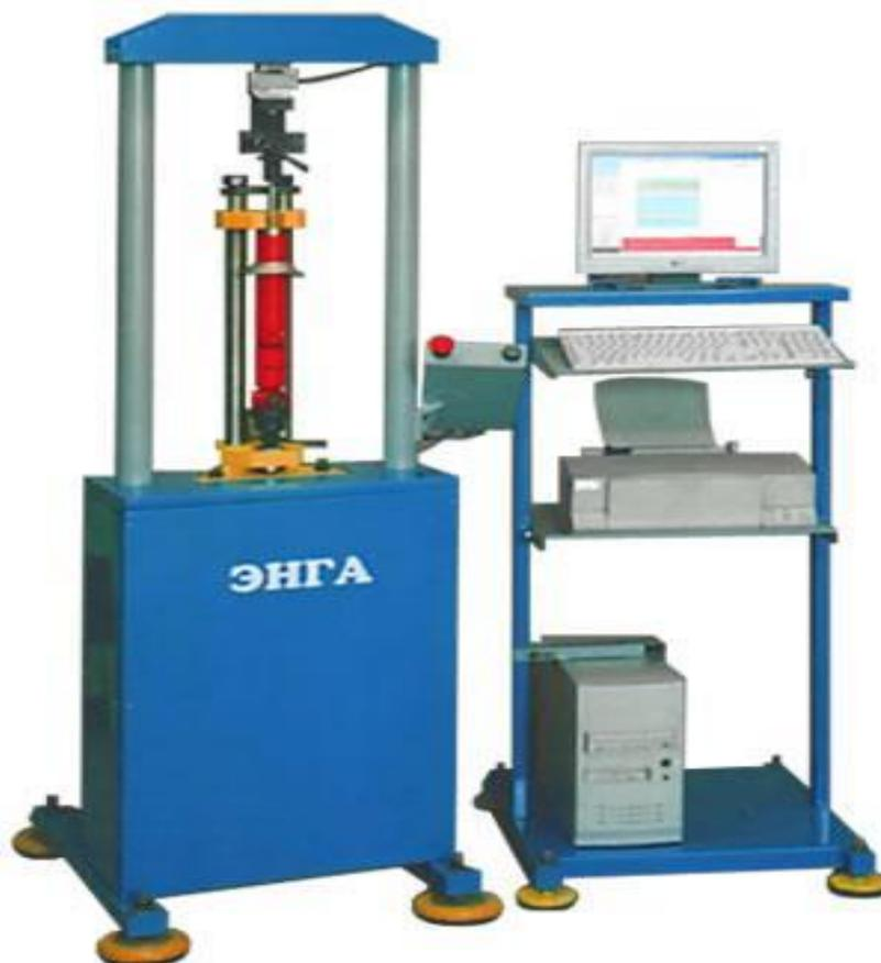
Рисунок 4 – Стенд для испытания амортизаторов
