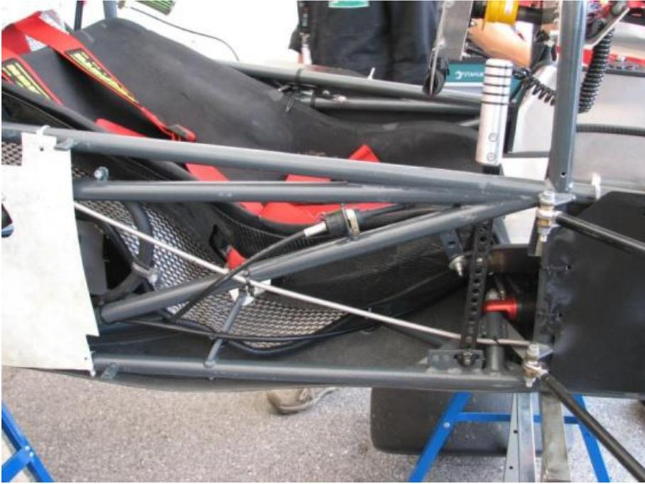
Рисунок 1.2– Механическая тросовая система переключения передач
