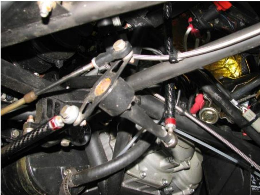
Рисунок 1.3– Механическая рычажная система переключения передач
