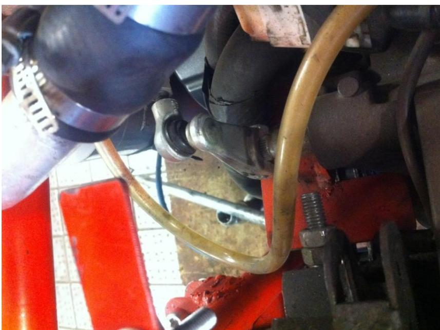
Рисунок 1.5 – Соединение тяги с коромыслом переключения передач КПП
