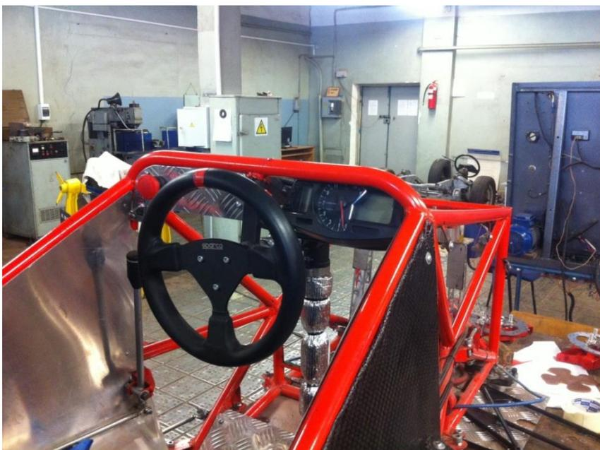
Рисунок 1.4 – Расположение рычага переключения передач и тяги
