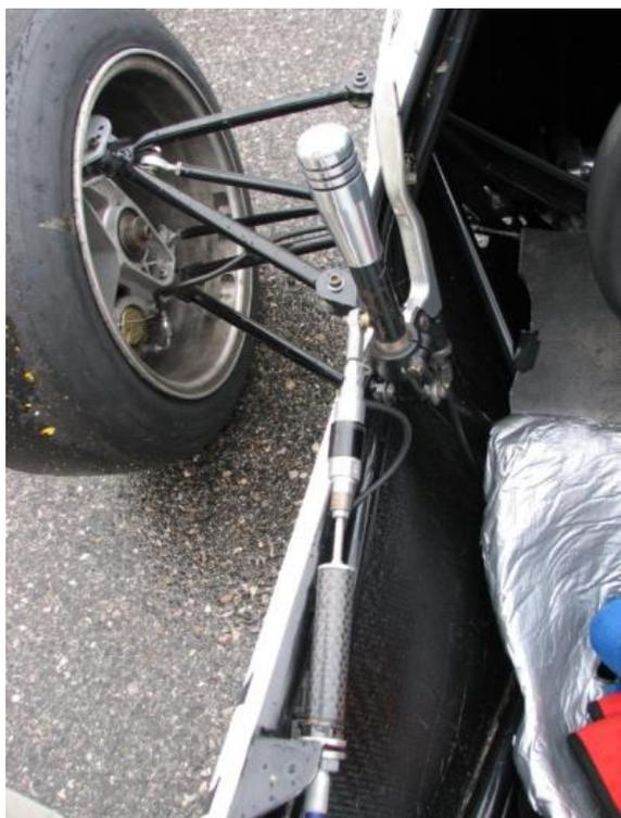
Рисунок 1.1– Гидравлическая система переключения передач
