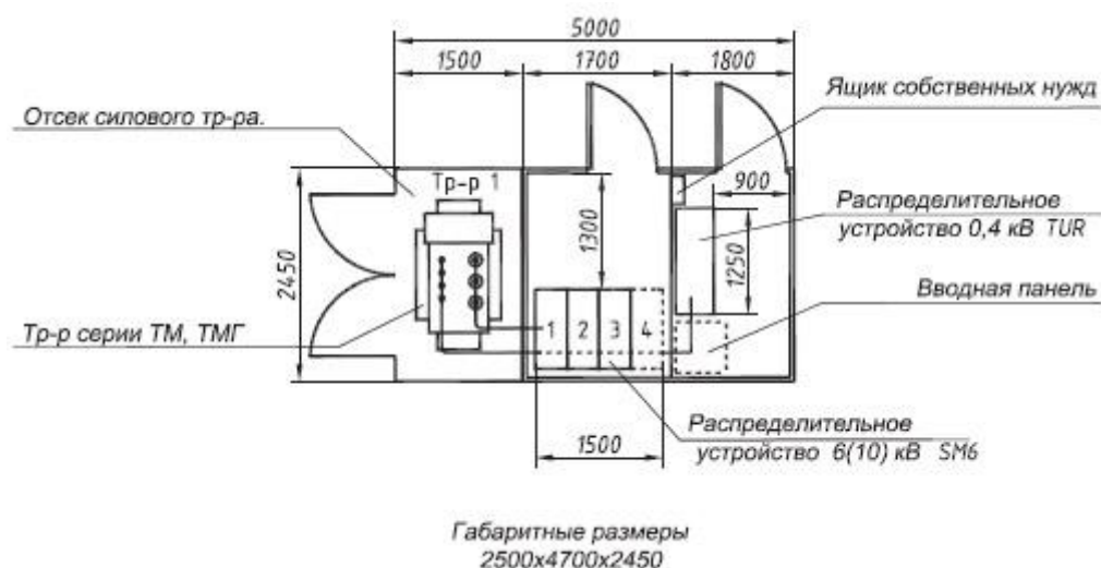
Рисунок 2 – План расположения оборудования ТП 10/0,4 кВ
