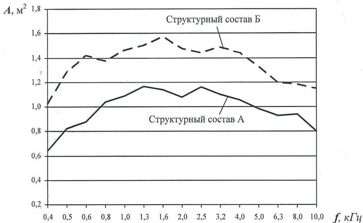
Структурный состав А – монолитный образец (90) 1000·1200 мм(1,2 м<sup>2</sup>) толщиной 50 мм, помещенный в полость замкнутой формованной емкости внешней звукопрозрачной оболочки, изготовленной из перфорированного ( $k_{пер}=0,2$ ) листа полимерного материала, толщиной стенки 2,5 мм.
