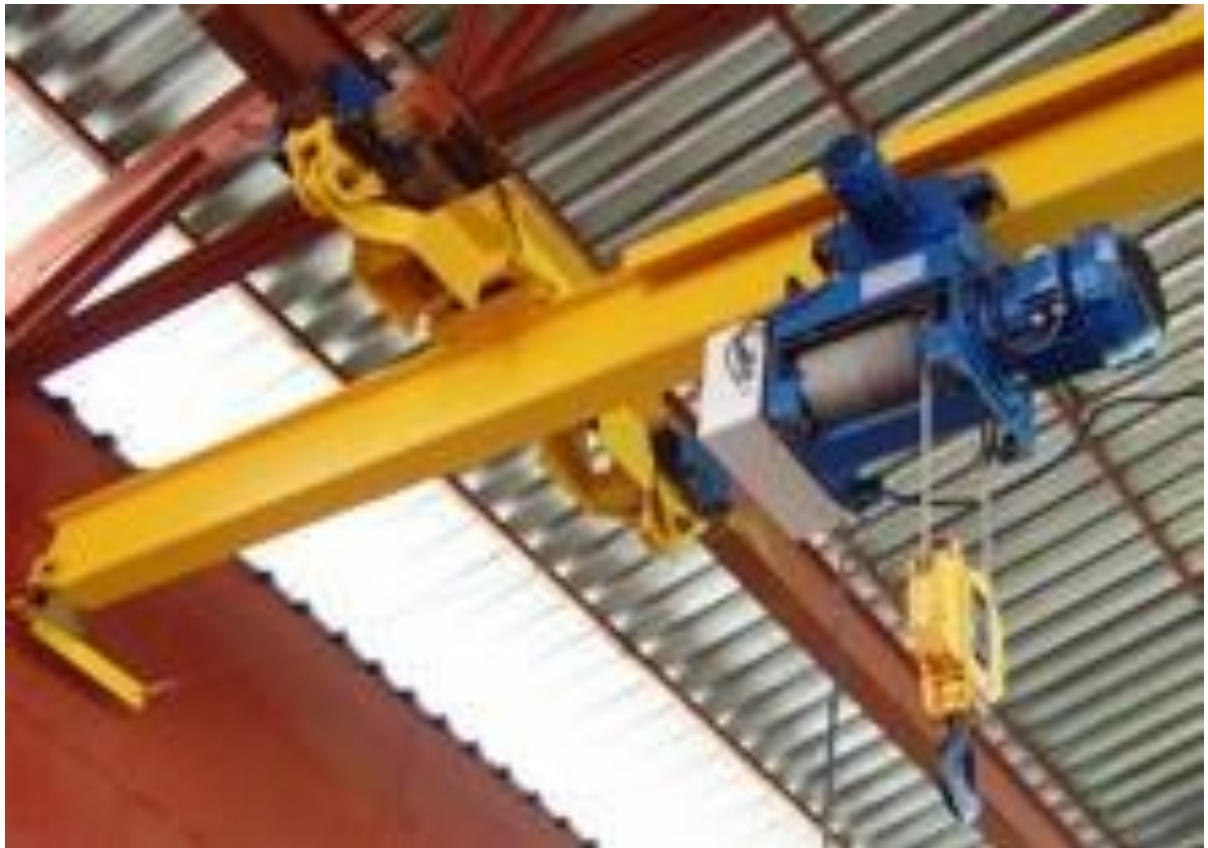
Рисунок 7 – Подвижная часть кран-балки КБ-10
