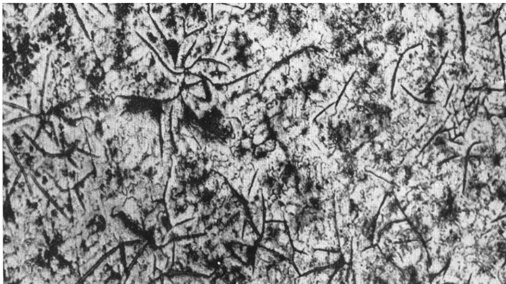
Рисунок 2.2 - Микроструктура наплавленного металла, х300
