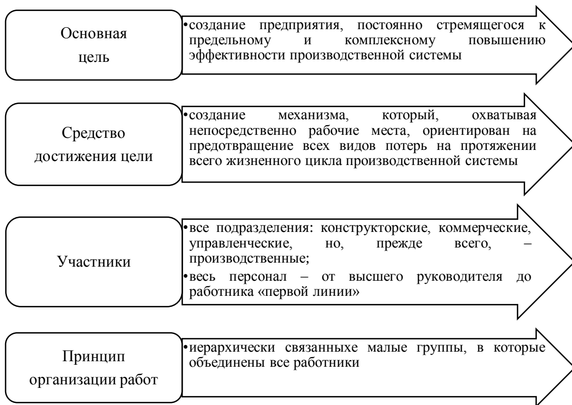
Рисунок 1.9 – Основные характеристики системы всеобщего обслуживания оборудования TPM
