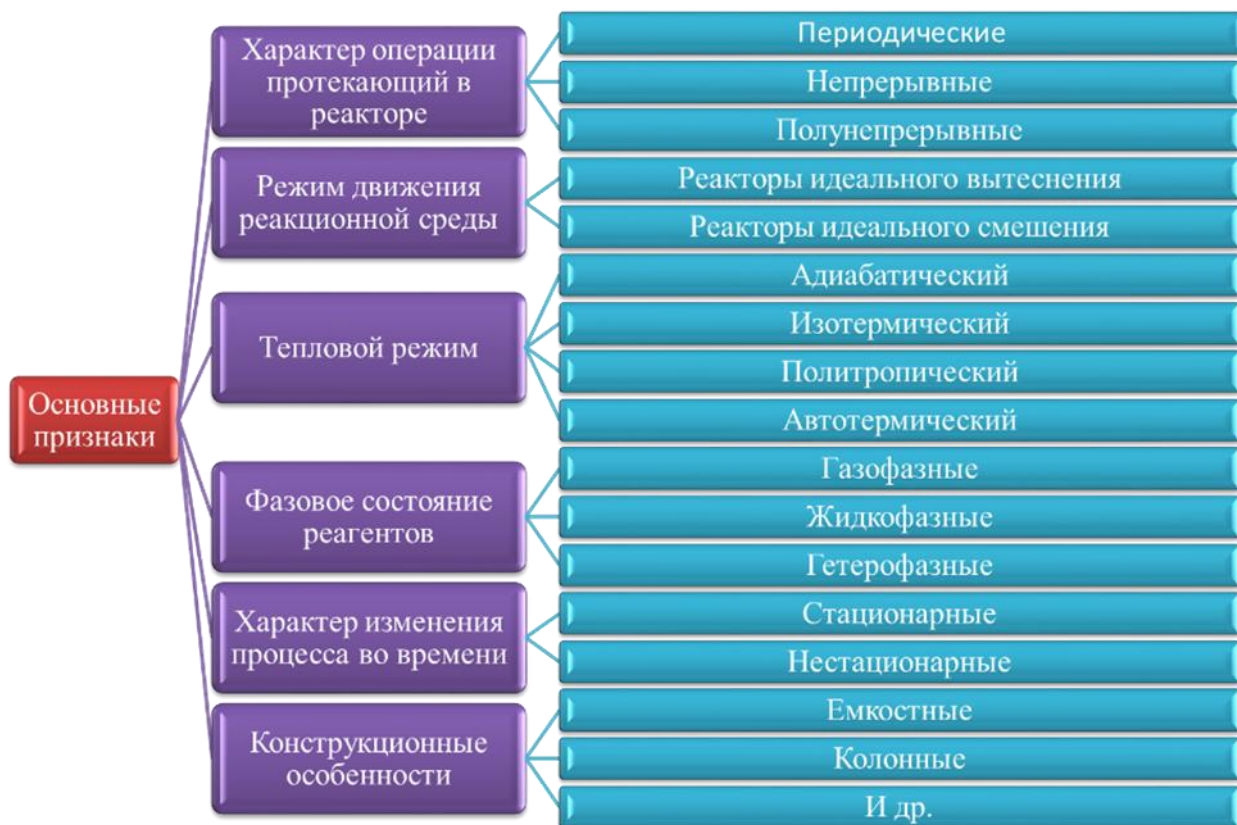
Рисунок 1.2 – Схема классификации химических реакторов по основным признакам [4]
