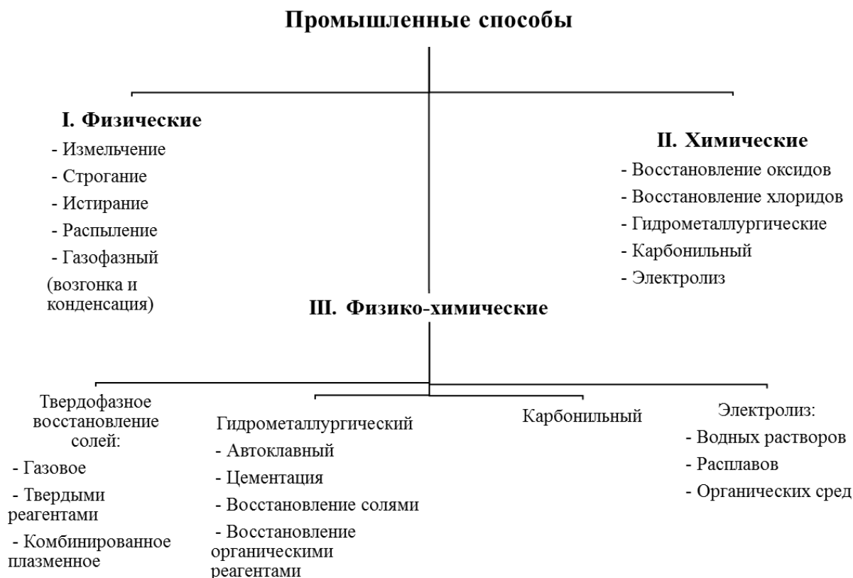
Рисунок 1.4 - Классификация способов получения порошков цветных металлов [17]
