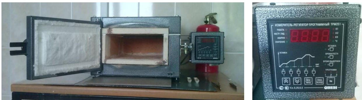
Рисунок 2.5 – Муфельная печь ПМ-700п: а – общий вид, б - измеритель-регулятор программный TRM251
