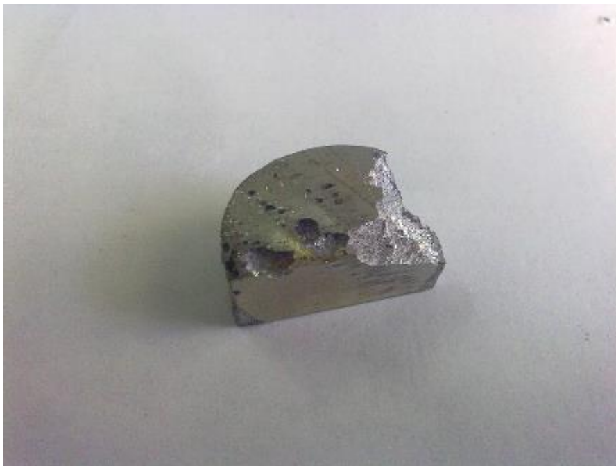
Рисунок 5 – Внешний вид образца чистого Mg после вакуумного отжига при 500^{\circ}\text{C} в течение 24 часов.
