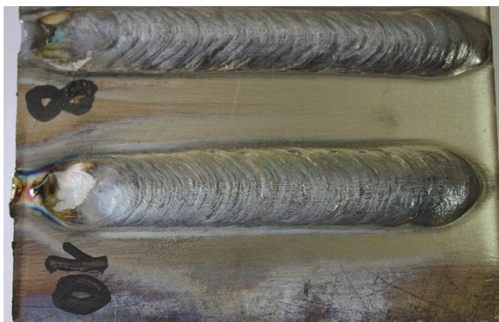
Рисунок 4.1 Визуальный результат наплавки интерметаллидных алюминидных покрытий.
