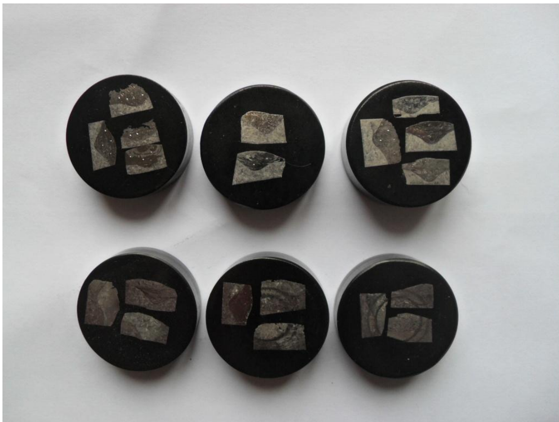
Рисунок 3.4 – микрошлифы наплавленных покрытий
