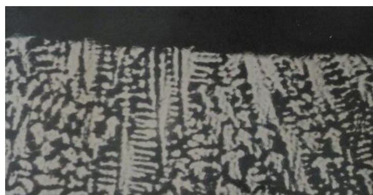
Рисунок 40 а – Особенности кристаллизации сварного шва с дефектом с лицевой стороны шва, х100
