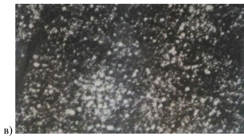
Рисунок 28 – Структура зоны термического влияния: а) аргонодуговая сварка; б) гелиево-дуговая сварка; в) электронно-лучевая сварка
