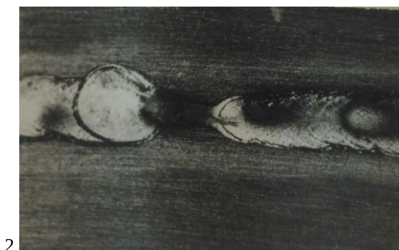
Рисунок 20 — Внешний вид напłyва на стали КВК: а) естественный напływ; б) искусственный напływ: 1 - лицевая сторона шва, 2 - обратная сторона шва
