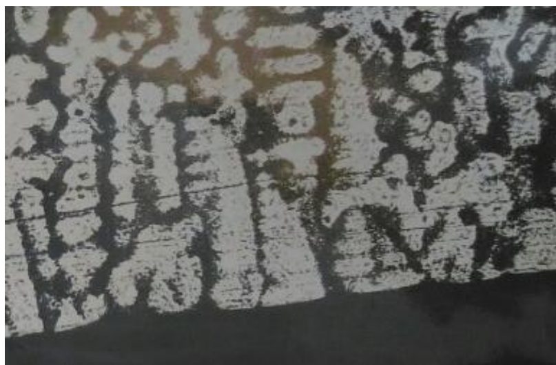
Рисунок 40 б – Особенности кристаллизации сварного шва с наплывом (обратная сторона шва)
