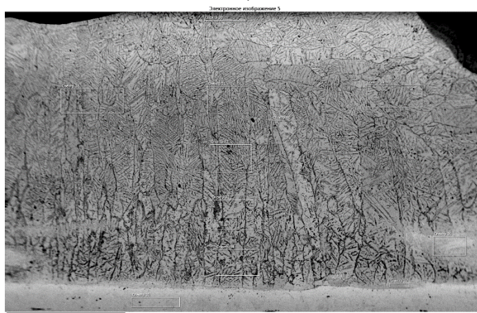
Рисунок 3.9 – Химический состав (а) многослойное (б) и электронное изображение (в) образца № 3 ( V_{\text{подAl}} 1,5 \text{ м/мин} )
