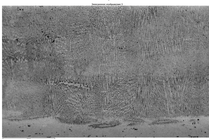
Рисунок 3.7 – Химический состав (а) многослойное (б) и электронное изображение (в) образца № 1 ( V_{\text{подAl}} 0,5 \text{ м/мин} )
