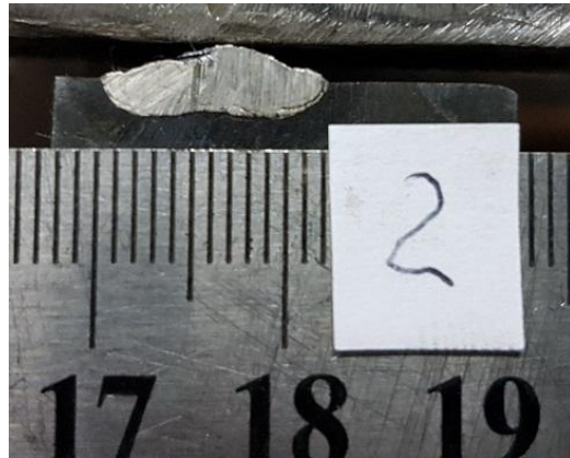
Рисунок 3.4 – Внешний вид (а) и поперечное сечение (б) наплавленного валика № 4 ( V_{\text{пода1}} 2,0 \text{ м/мин} )
