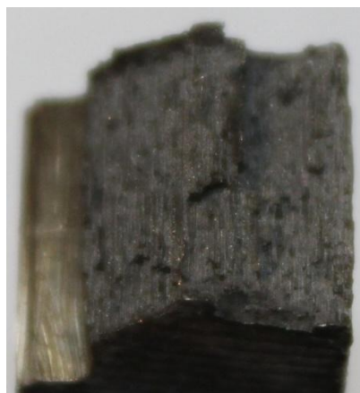
Рисунок 3.18 – Характер излома при закалке 860°C и последующем отжиге при температуре 600°C
