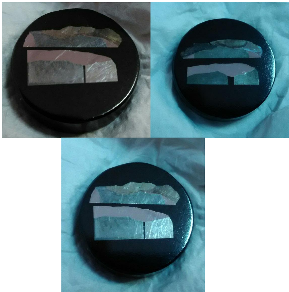
Рисунок 2.3 – Образцы для исследования химического состава методом РЭМ в эпоксидной смоле
