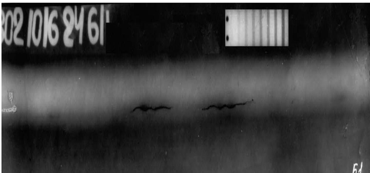
Рисунок 3.12 – Продольные трещины
