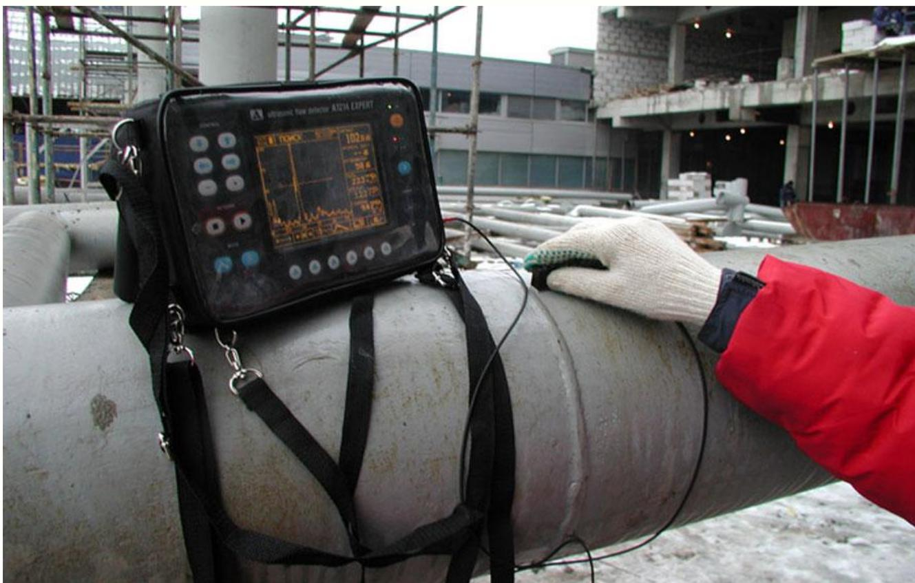
Рисунок 1.23 - Проверка сварных швов ультразвуковой дефектоскопией
