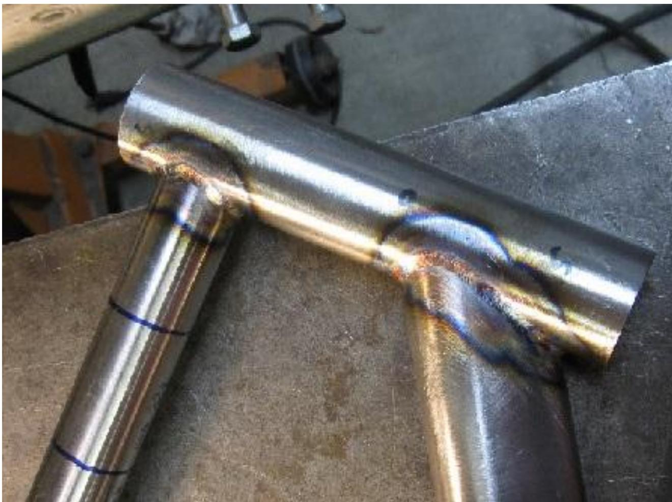
Рисунок 1.5 – Врезка в трубу
