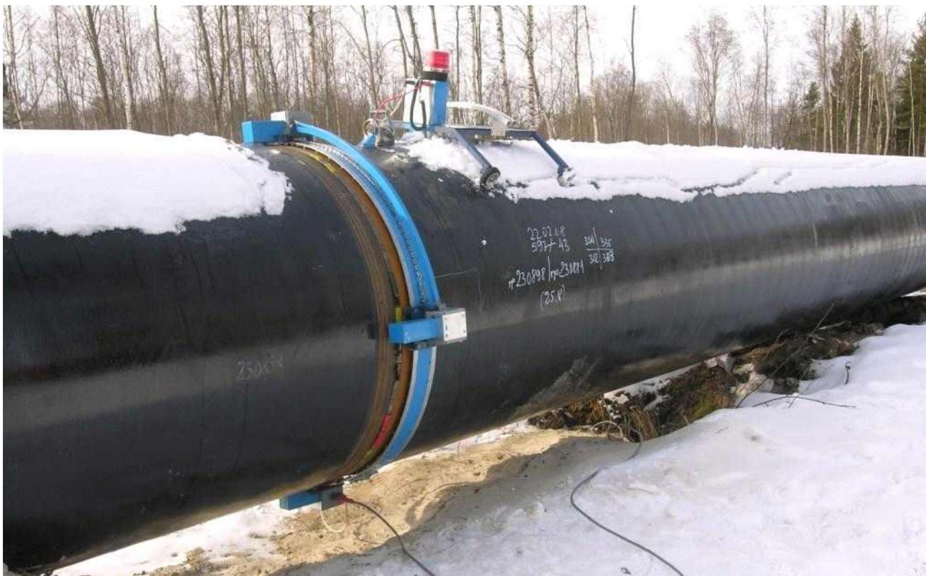
Рисунок 1.26 – Установка для цифровой радиационной дефектоскопии
