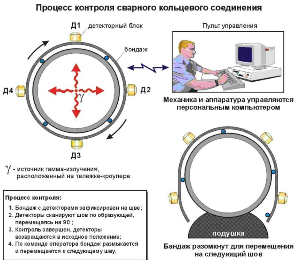
Рисунок 1.29 – Процесс контроля сварного кольцевого соединения
