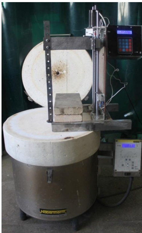
Рисунок 2.17 – Фотография автоматической установки для испытания эрозионной стойкости наплавленных покрытий [102]
