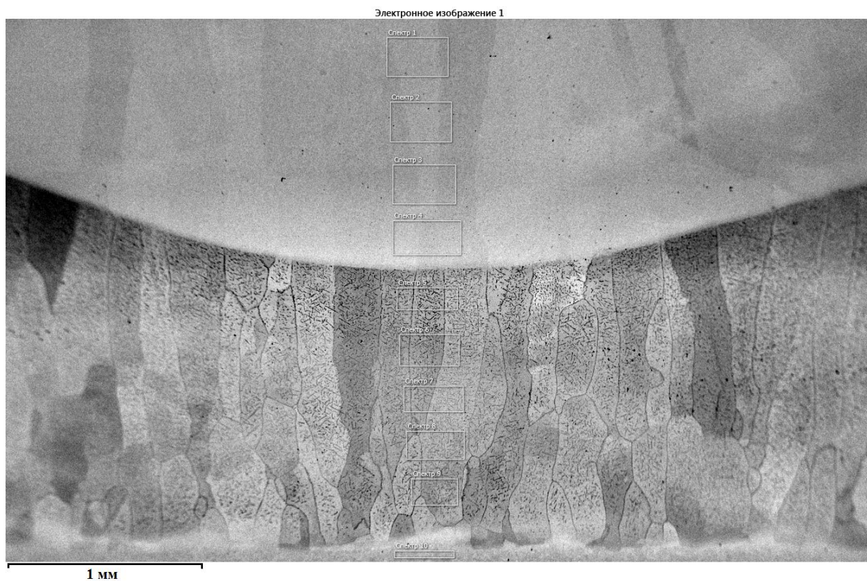
Рисунок 4.11 – Макроструктура наплавленного покрытия системы Fe-Ni-Al
