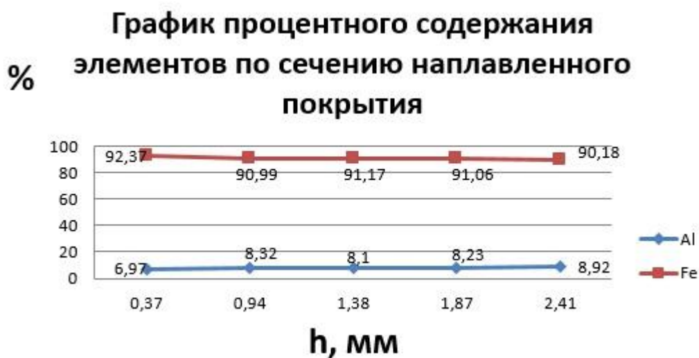
Рисунок 3.26 – Химический состав образца V_H = 0,09 м/мин, V_{Al} п/пп = 3 м/мин; V_{Fe} п/пп = 4 м/мин; U_{д Al} = 17 В, U_{д Fe} = 27,5 В
