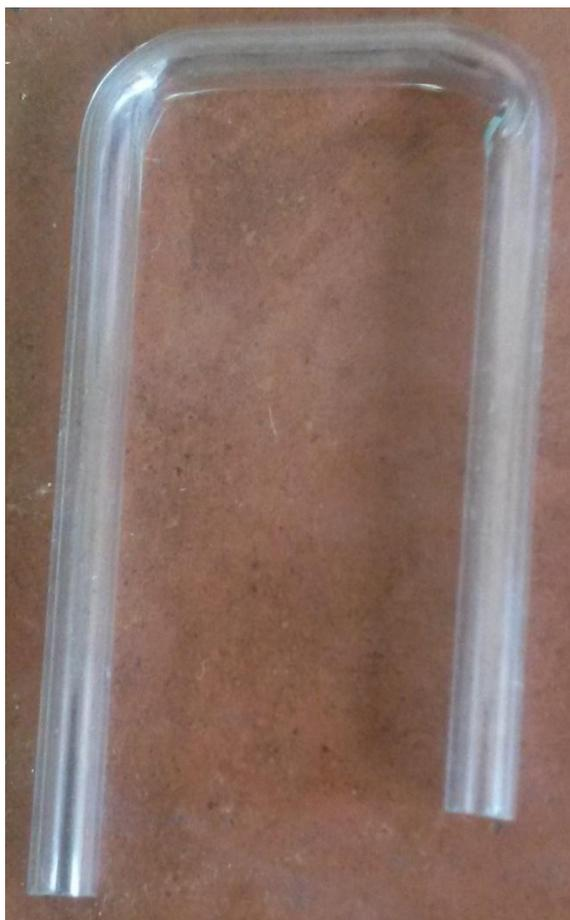
Рисунок 14 — Стекланный мостик, соединяющий ячейки
