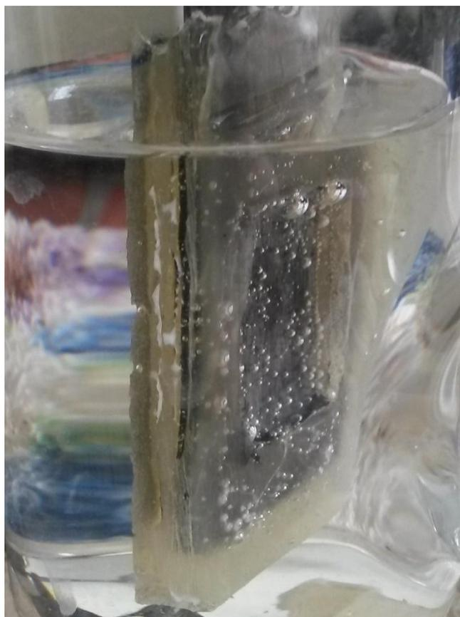
Рисунок 17 — Образование пузырьков водорода на поверхности рабочего участка
