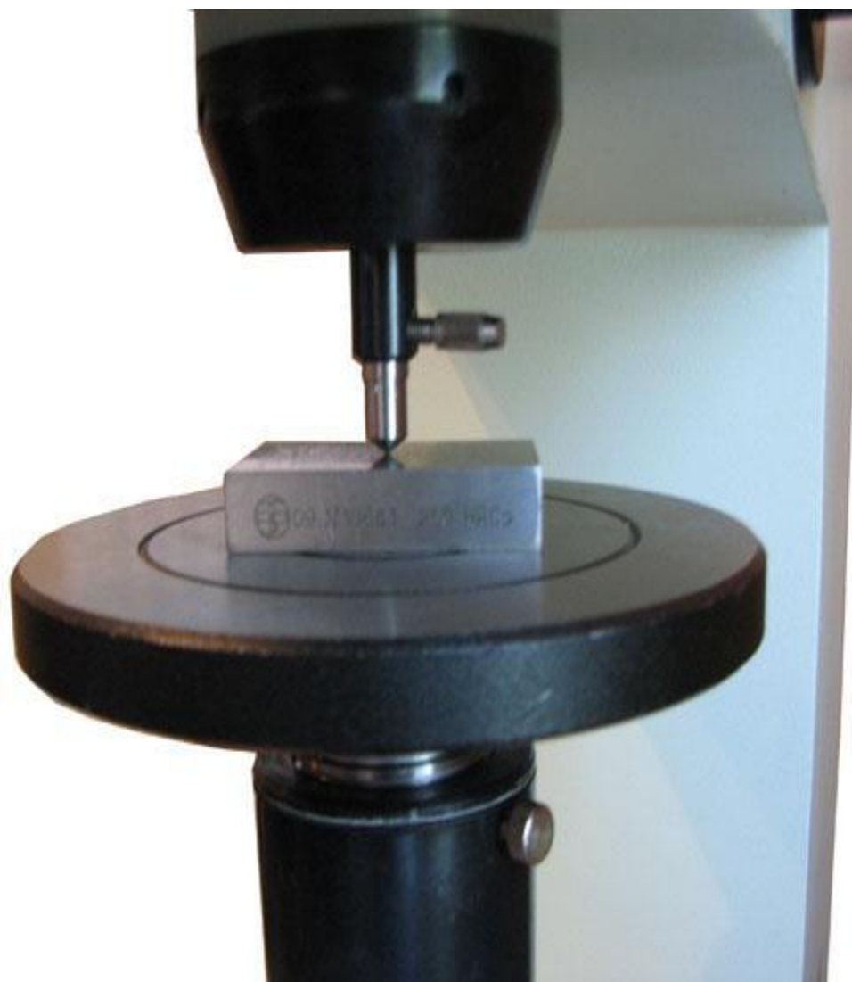
Рисунок 42- Испытания на твердость вдавливанием
