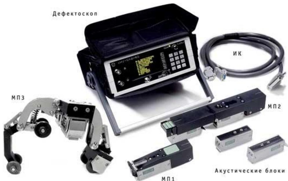
Рисунок 3.7 – Состав комплекта для ультразвукового контроля
