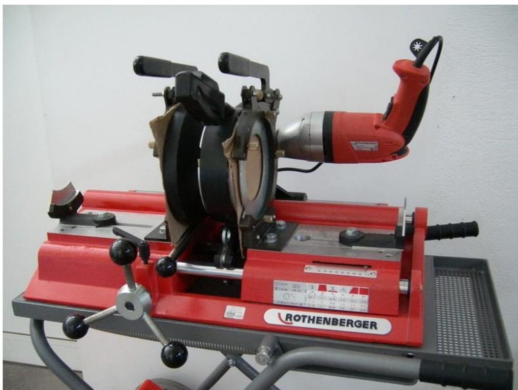
Рисунок 3.13 – Машина для стыковой сварки полимерных труб нагревательным элементом Roweld P160 SANILINE, которая использовалась при экспериментальной сварке
