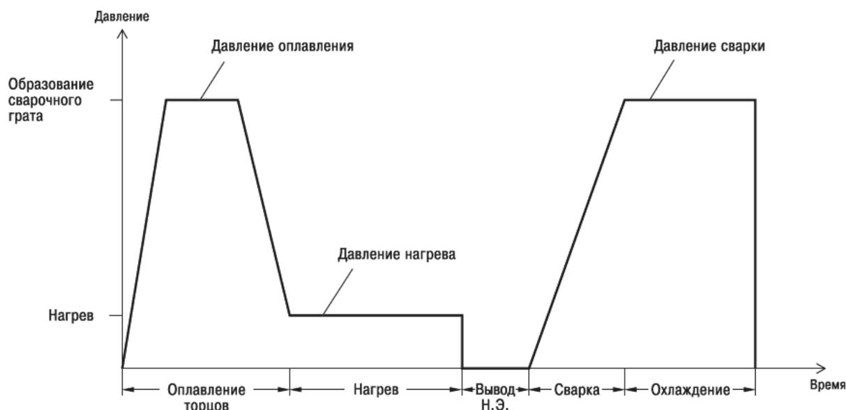
Рисунок 2.1 – Циклограмма процесса сварки встык нагретым инструментом
