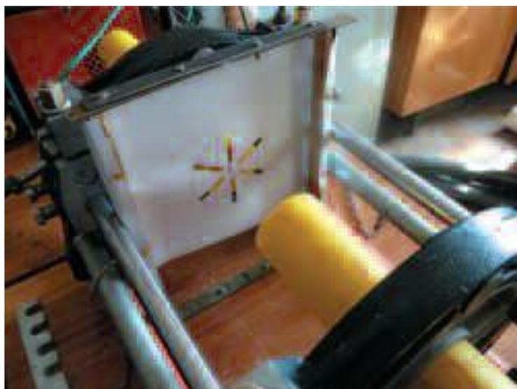
Рисунок 3.15 - Установка шаблона для создания заданной площади сварки в сварном соединении
