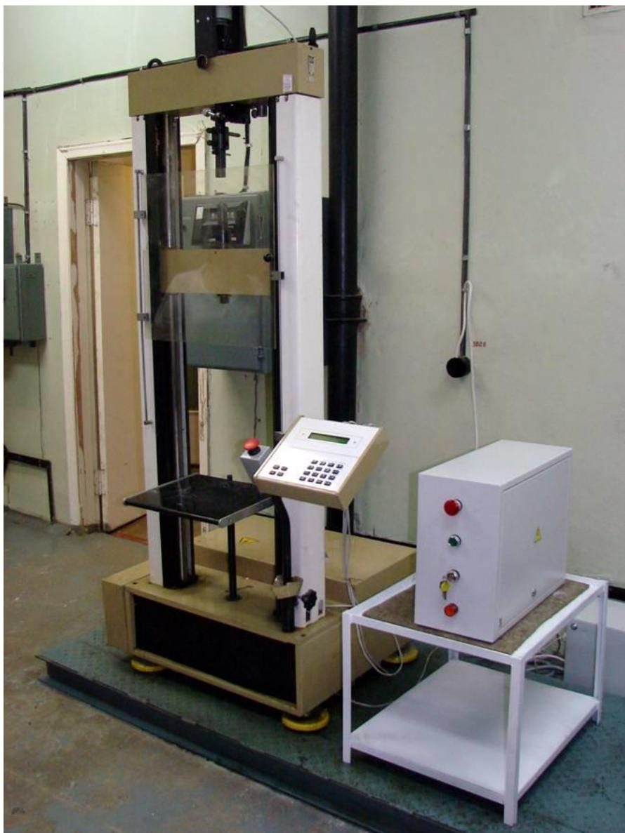
Рисунок 3.6 – Измерительный комплекс на базе разрывной машины Р-50
