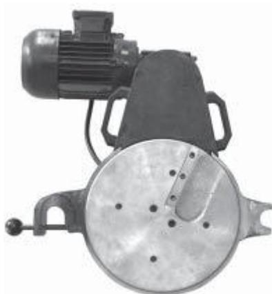
Рисунок 2.9 – Торцеватель для сварки полимерных труб
