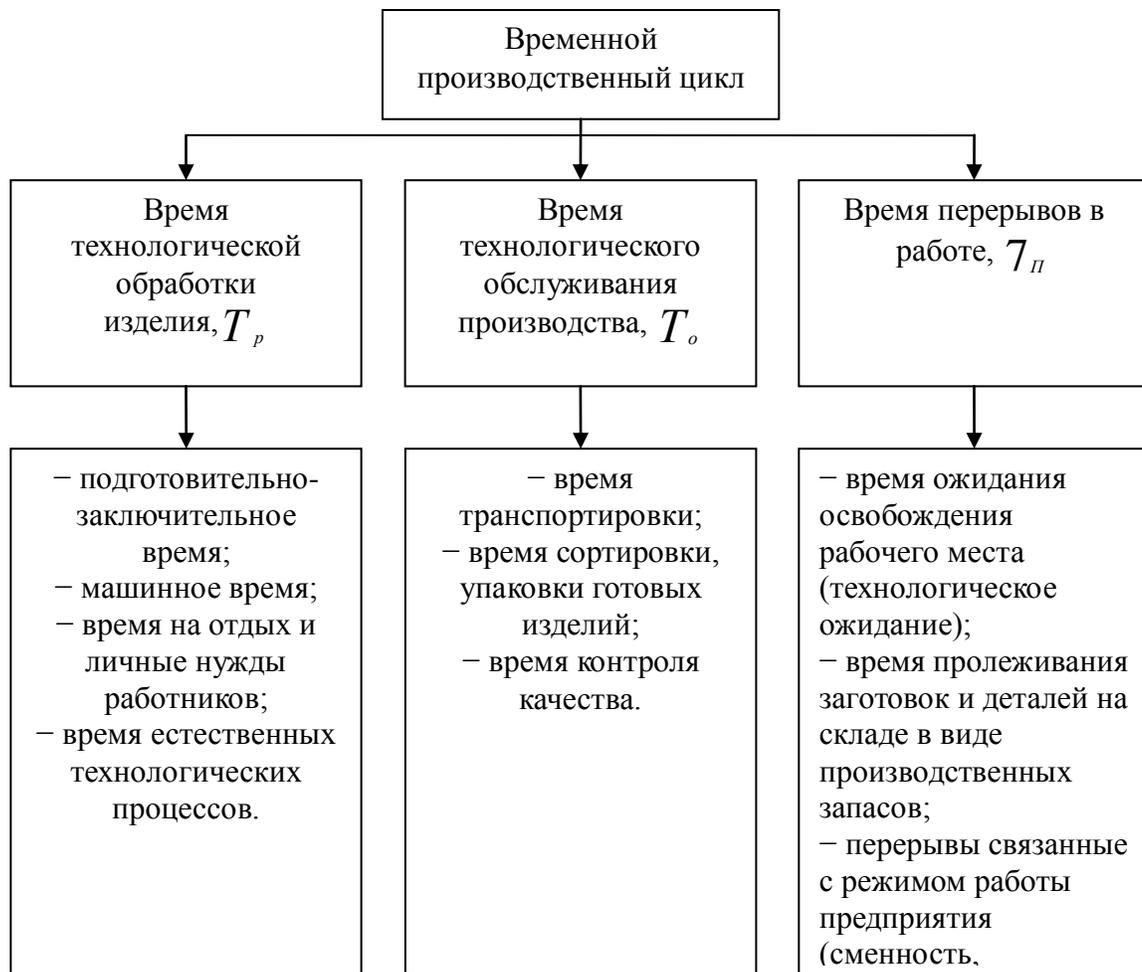
Рисунок 1.2 – Структура временного производственного цикла
