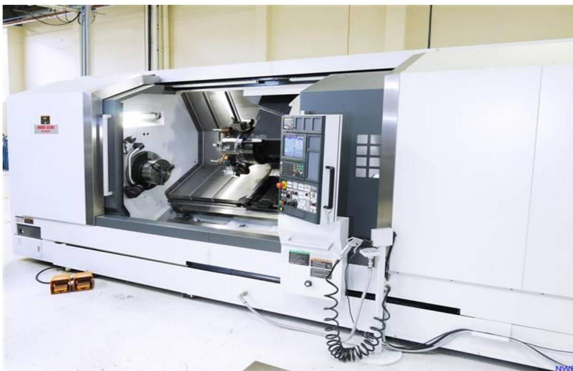
Рисунок 2.6.1.1 – Токарно-фрезерный обрабатывающий центр NL3000Y/2000 с системой ЧПУ M720MB
