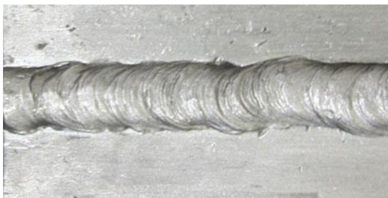
Рисунок 1.3 – Сварочный шов, выполненный электродами ОЗАНА-1
