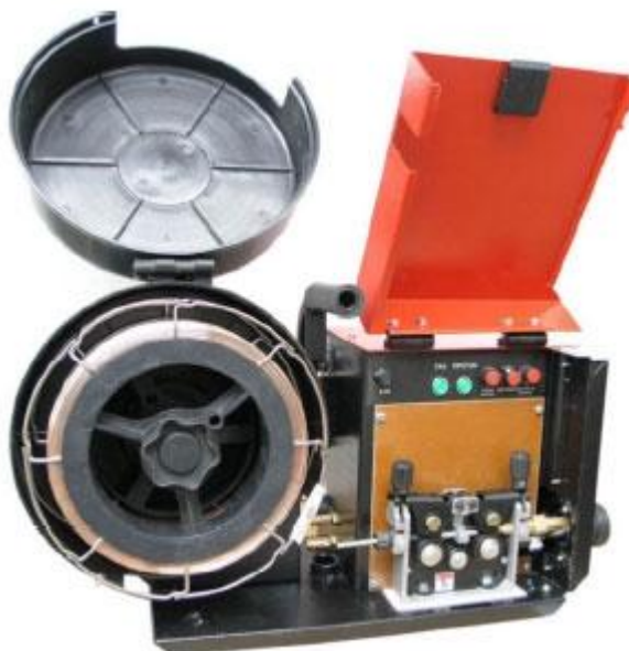
Рисунок 2.7 - Механизм подачи ПДГ 312-5
